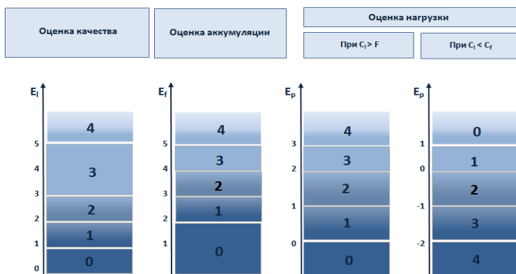
Рис. 9 Иллюстрация единой шкалы для перевода численных значений однокритериальных оценок ( E_j ) в баллы. Последние обозначены цифрами в окнах, расположенных справа от осей, разбитых на характерные отрезки в зависимости от критерия оценки
