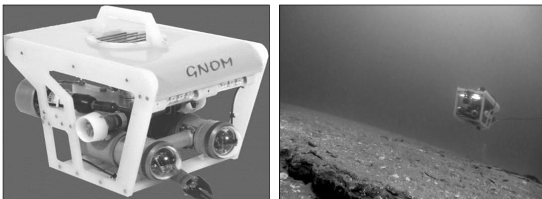
**Рис. 1** Подводный аппарат «Супер ГНОМ Про»
