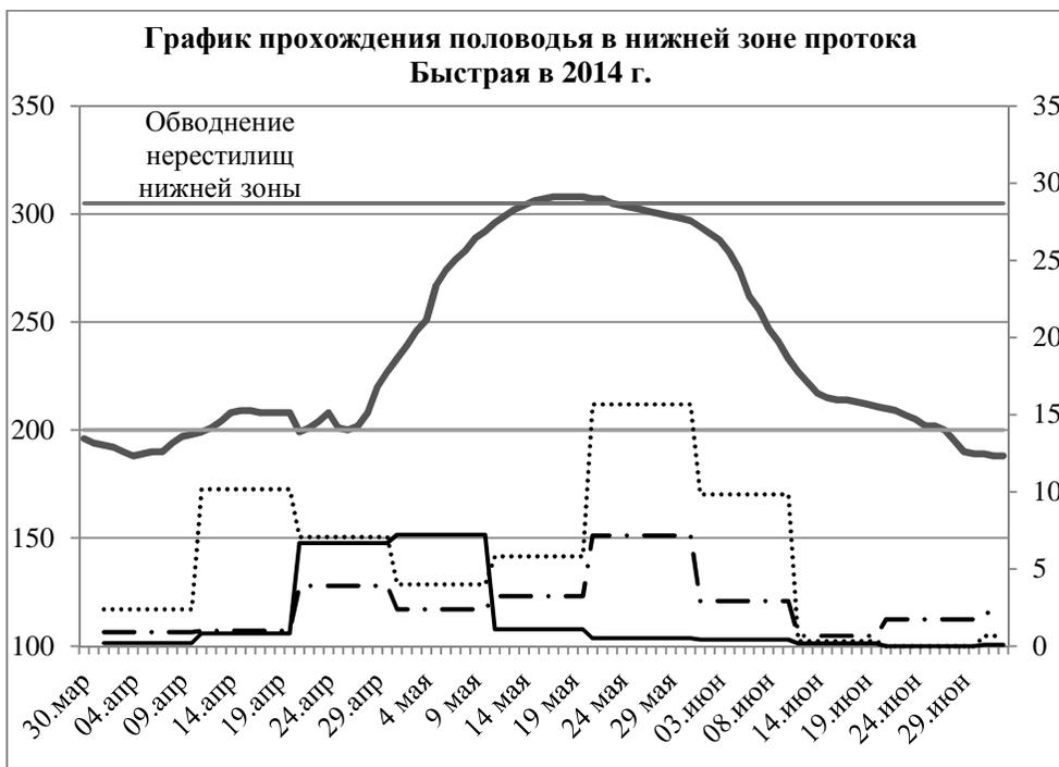
**Рис. 2** График прохождения половодья 2014 г. (по данным рейки в пр. Быстрая)
