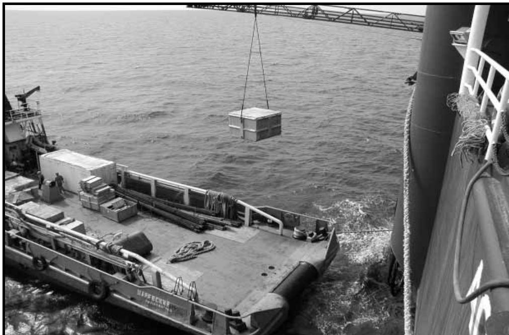
Рис.4.3 Перегрузка контейнеров с твердыми отходами на транспортно-буксировочное судно
