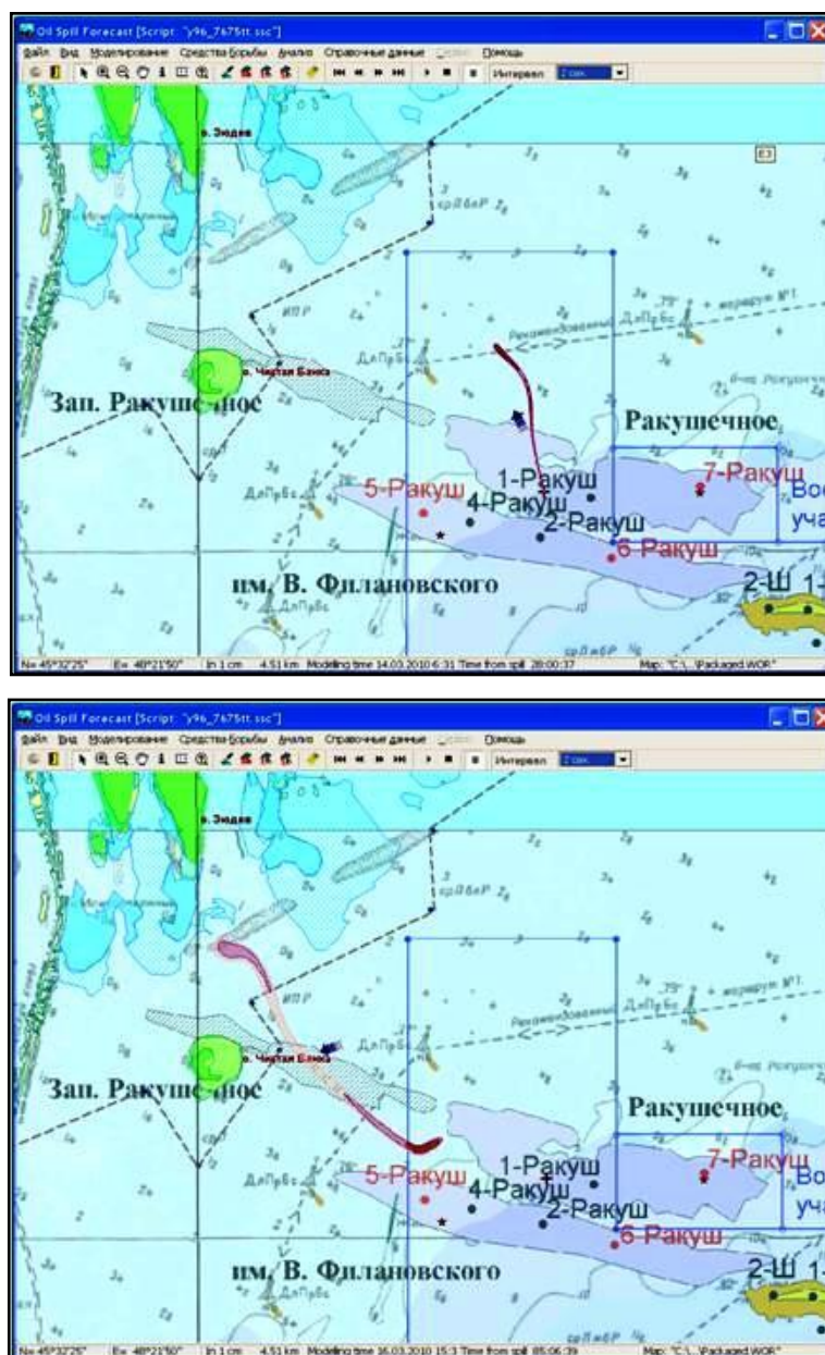
Рис. 4 Пример прогноза распространения и трансформации аварийного разлива нефти
