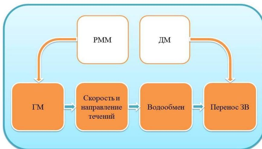
**Рис. 19** Технология расчета водообмена и переноса загрязняющих веществ между различными частями Каспийского моря. РММ – региональная метеорологическая модель; ГМ – гидродинамическая модель; ДМ – данные мониторинга; ЗВ – загрязняющие вещества
