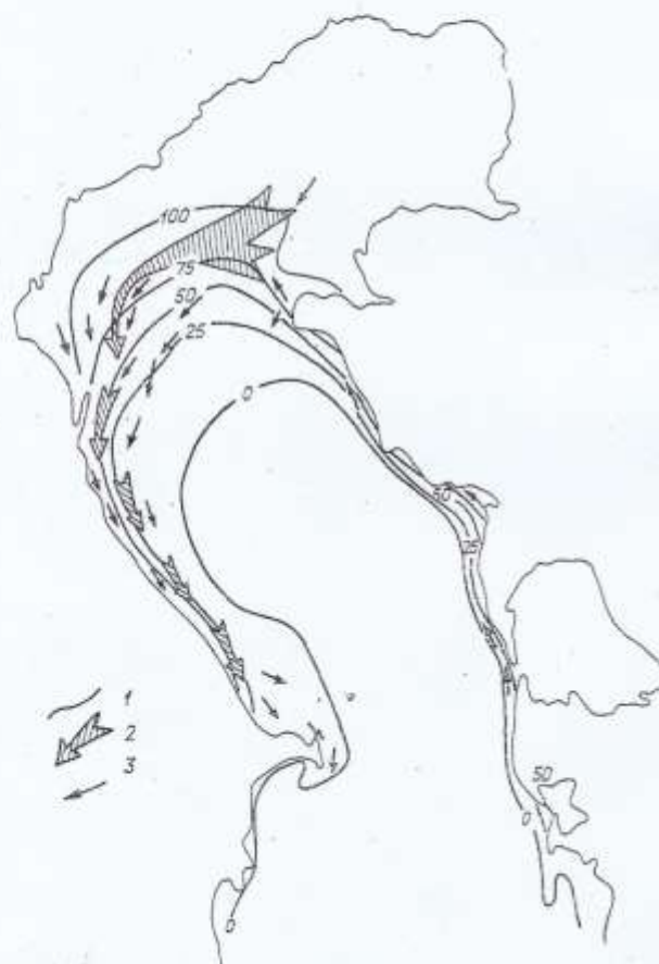
Рис. 8.1. Вероятность ледообразования (наличие льда) и схема дрейфа плавучего льда.
